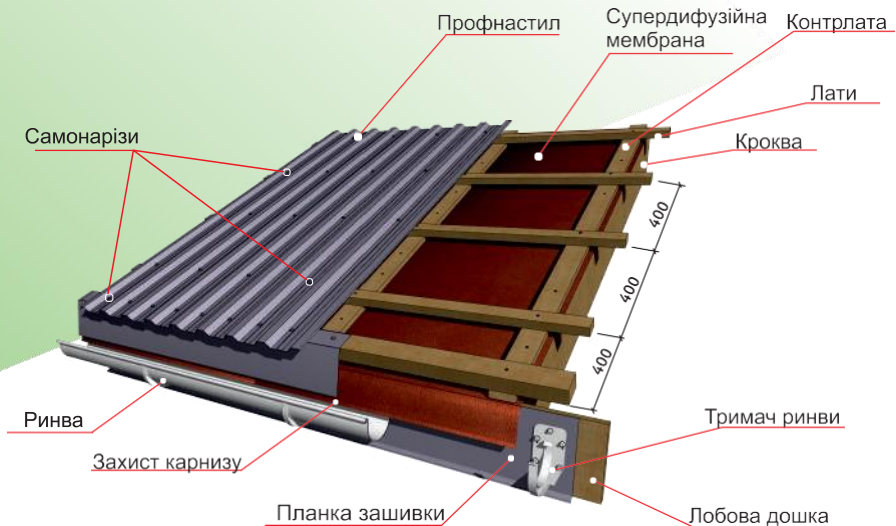
Рис.12 Облаштування обрешітки для профнастилу
